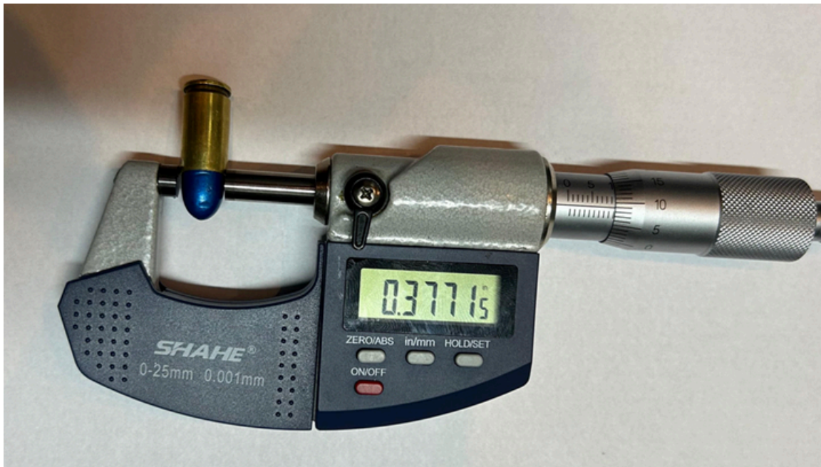
Imagem 3 – Medição do Factory Crimp após o termino do processo de recarga
