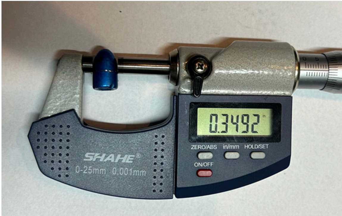
Imagem 4 – Medição após a zona de 6mm acima da base do projétil
