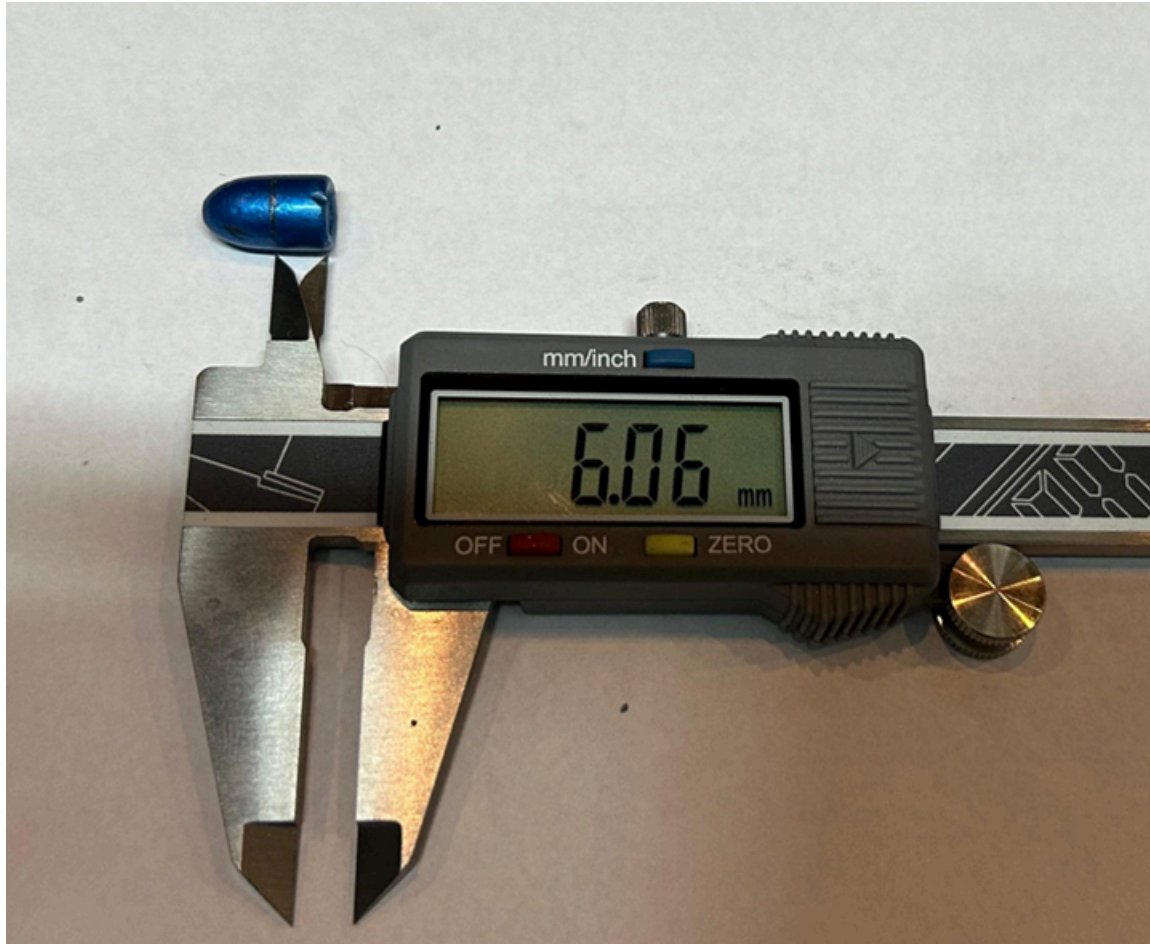
Imagem 6 - Medição da zona onde a calibragem nominal tem contato com o cano / enraçamento
